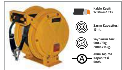
Topraklama ve Kaynak için Elektrik Aktarım Tamburu Kilitlemeli - Metal Gövde
